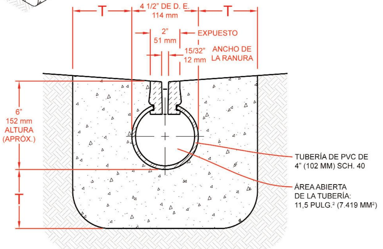
**T** = LA ESPECIFICACIÓN DEL INGENIERO ESTRUCTURAL, EL ESPESOR DE LA LOSA DE PISO O 4" (102 MM) COMO MÍN. (EL QUE SEA MAYOR)
