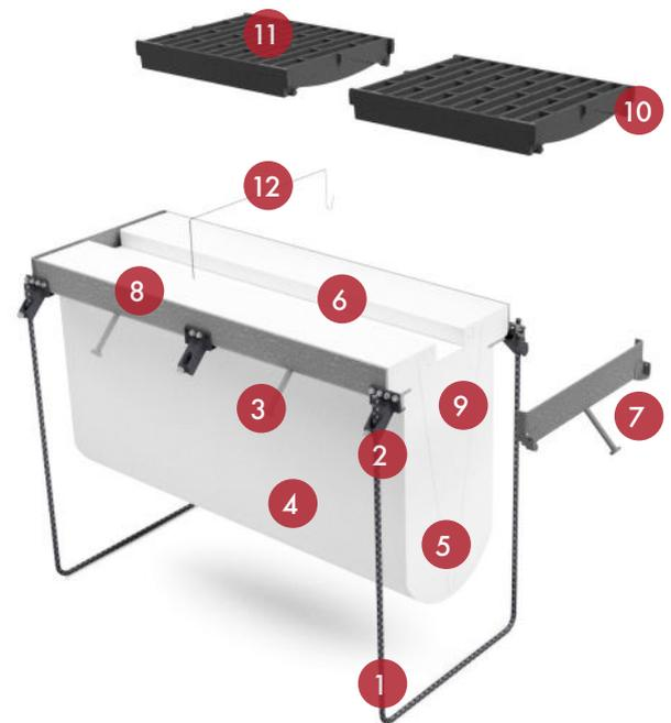
**10. Système de verrouillage** - Le système breveté de retenue de grille non rigide à quatre coins assure une rétention longitudinale et verticale, tout en éliminant les contraintes thermiques qui causent traditionnellement des fissures dans le béton des systèmes visser.
